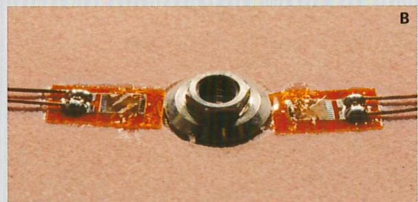
Figuras 2 – A. Implante intraoral instalado com extensômetros colados em mesial e distal. B. Implante extraoral instalado com extensômetros colados em mesial e distal.
